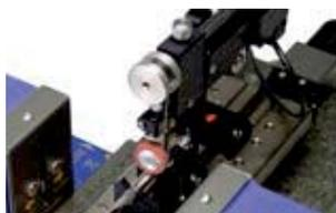
精密線性滑軌安裝在花崗石基座平台：V型溝槽不銹鋼工作台，總長度400mm，可使用範圍160mm，手動和測微計驅動。
