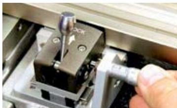
**RUNOUT(偏擺)**的計算為所有切削刃在完整旋轉期間峰值位置最大擺動。
